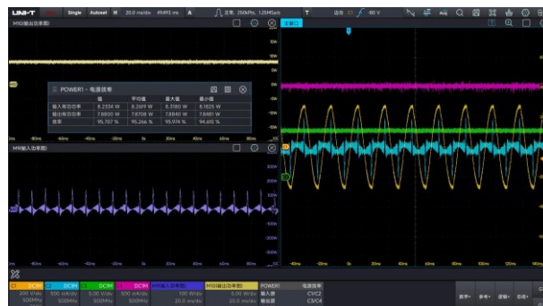
分析输入功率/输出功率的比值计算电源输出效率，一个优秀的电源输出效率应在 95%以上
